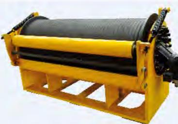
Основная лебедка имеет функцию "свободного спуска", что обеспечивает синхронность буровой головки и троса лебедки, удобство в эксплуатации.
