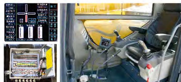
Интерфейс большого цветного экрана был спроектирован на основе многолетнего опыта ведения работ, настройки интерфейса полностью соответствуют фактическим реалиям работ, что делает его использование максимально удобным.
