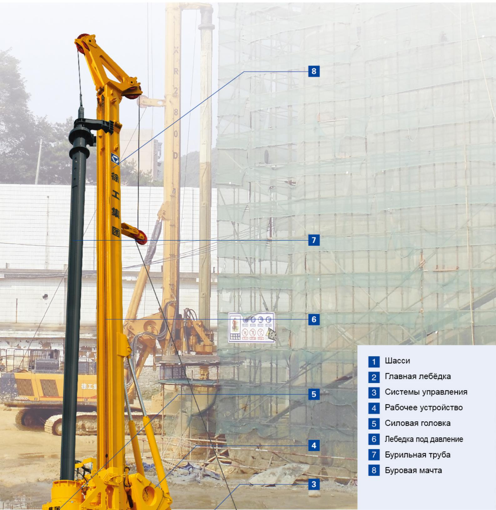
Специальное гидравлическое гусеничное шасси телескопического типа обеспечивает сверхвысокую устойчивость и удобство при транспортировке. Импортный двигатель Cummins с турбонаддувом (экологический стандарт Евро III), высокой мощности, с резервом мощности достаточным для ведения работ на возвышенностях. Уровень шума и выхлопа соответствует государственным стандартам. Постоянный уровень мощности, оптимальный выход силы позволяют установке находиться в отличном рабочем состоянии.
