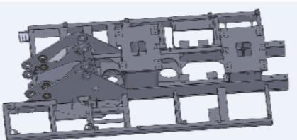
В поворотном механизме были задействованы импортные компоненты. Имеется опорный вращающийся механизм и механизм автоматического возврата в исходное положение, что позволяет значительно сэкономить время и усилия. Платформа с радиусом вращения 360°, делает возможным осуществить удаление засорений под любым углом.
