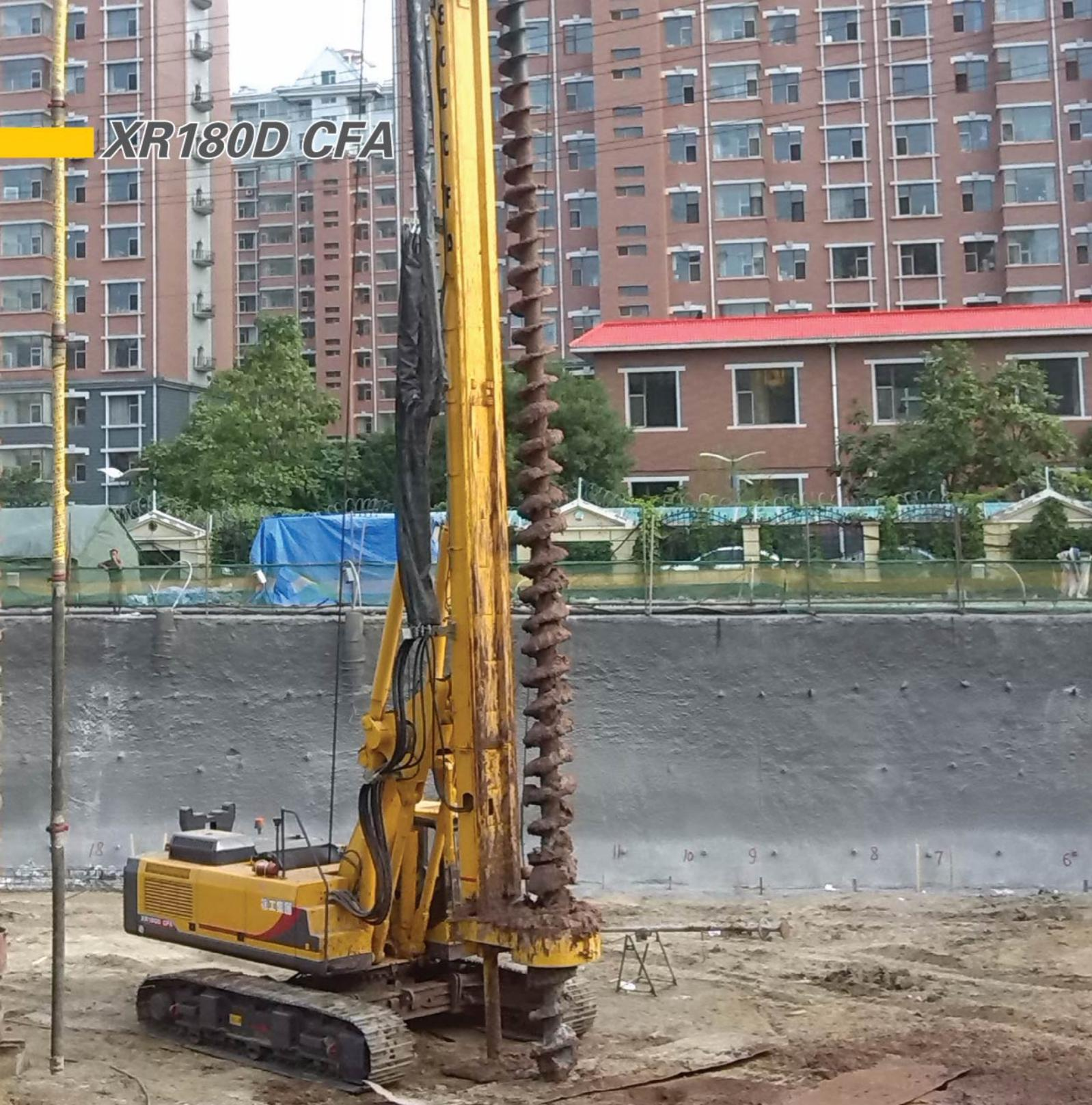
Данный вид оборудования является многофункциональным и при смене специальных устройств может использоваться при бурении методом CFA или как роторная буровая установка.
