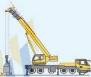
Изгиб стрелы при подъеме грузов Boom deformation while the load is clearing of the ground
