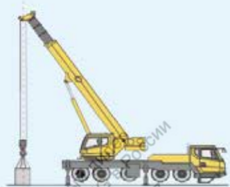
Автоматическая компенсация вылета вертикальным подъемом Preparation of lifting operation
