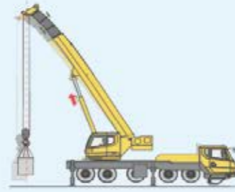
Автоматическая компенсация вылета вертикальным подъемом Vertical load lifting due to automatic elevating compensation
