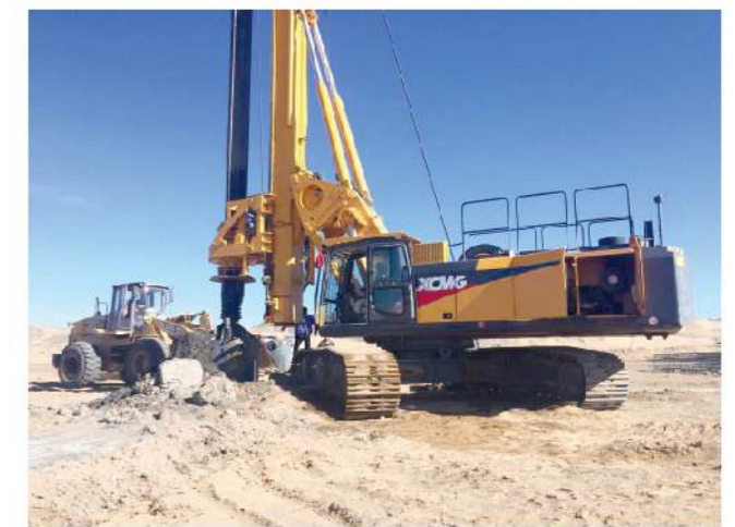
屹立戈壁滩，XR360旋挖钻机助力 京新高速公路工程建设 XR360 is working in the desert
