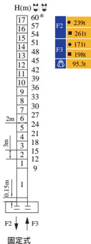
H 吊钩高度 Height of the hook ● 工作状态 In service ■ 非工作状态 Out of service
